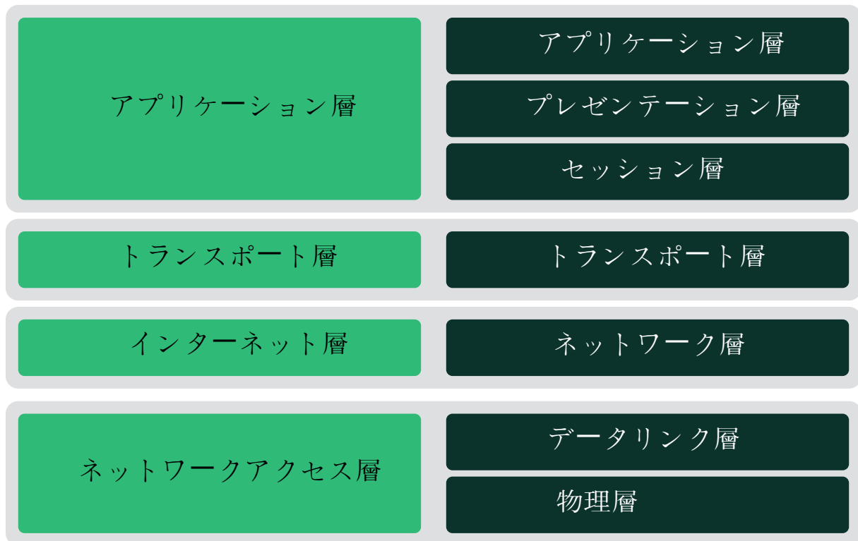
図 13.1: TCP/IP での単純化したレイヤモデル
